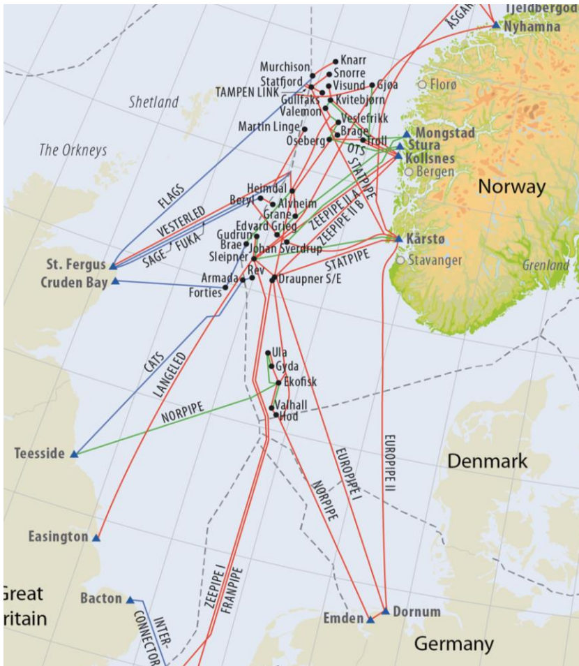
Figuur 10: Gaspijpleiding netwerk in de Noordzee, opgehaald van: https://www.norskpetroleum.no/en/production-and-exports/the-oil-and-gas-pipeline-system/
