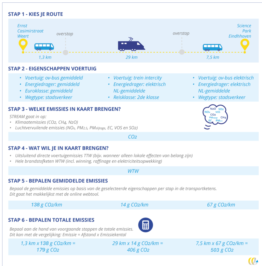
Figuur 15 - Voorbeeldberekening op basis van emissiekentallen
